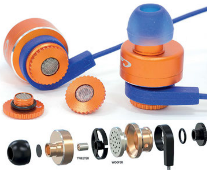
Il modello Super Titta è realizzato con due driver: uno dinamico per la gamma bassa ed uno ad armatura bilanciata per le gamme media e alta. L'accordo acustico può essere variato montando le diverse chiusure posteriori a corredo.
