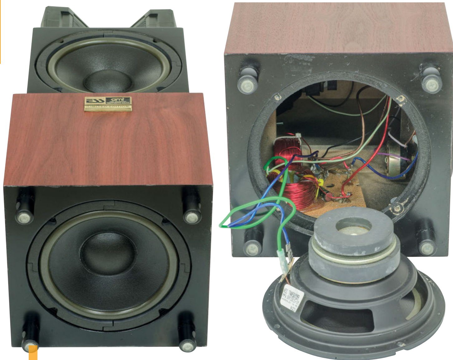
Sul fondo del mobile è presente un secondo woofer da 6", non un passivo come nella versione grande AMT Limited.
